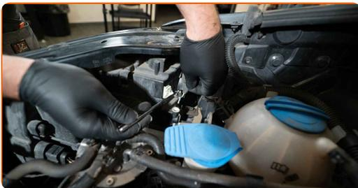
**3** Lösen Sie die Glühlampenhalterung, indem Sie diese etwa um 30° drehen. Entfernen Sie die Halterung aus dem Scheinwerferträger.
