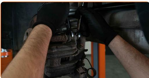
**11** Entfernen Sie den Bremssattel.
