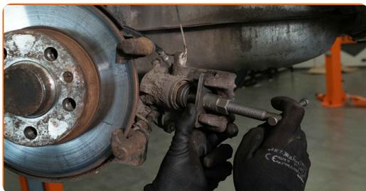
**15** Behandeln Sie die Rückseite der neuen Bremsbeläge. Behandeln Sie den Bremssattelhalter dort, wo er die Bremsbeläge berührt. Benutzen Sie eine Anti-Quietsch-Paste.
