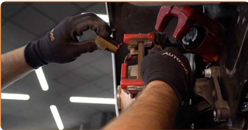
**Austausch: Bremsbeläge – SKODA Scala Schrägheck. Tipp von AUTODOC:**
