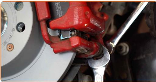
**Austausch: Bremsbeläge – SKODA Scala Schrägheck. Tipp von AUTODOC-Experten:**
