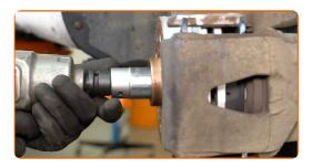
Entfernen Sie die Befestigungsschraube.
