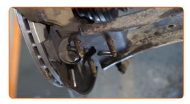
Schrauben Sie das Befestigungselement ein, das das Traggelenk mit dem Querlenker verbindet. Verwenden Sie Stecknuss Nr. 16. Verwenden Sie einen Ratschenschlüssel.
