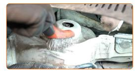
Lösen Sie die oberen Befestigungen des Federbeins. Verwenden Sie Stecknuss Nr. 13. Verwenden Sie einen Ratschenschlüssel.
