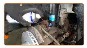
Ziehen Sie den Bremsschlauch Halterung ab. Lösen Sie die Halterung des ABS-Kabelbaums. Verwenden Sie Ring-Gabelschlüssel Nr. 10.
