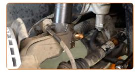
Entfernen Sie den Träger unter dem Achsschenkel.
