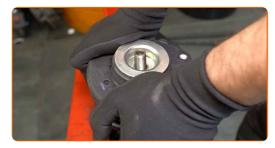
Ziehen Sie die Federbeinkolbenstangenmutter an. Verwenden Sie Stecknuss Nr. 21. Verwenden Sie Inbusschlüssel Nr. H6. Verwenden Sie einen Drehmomentschlüssel. Ziehen Sie ihn mit 60 Nm Drehmoment fest.
