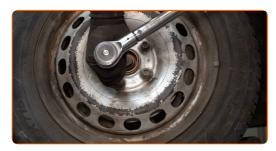
79 Entfernen Sie den Wagenheber sowie die Unterlegkeile.
