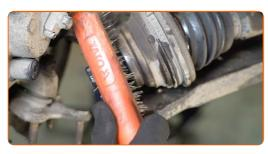
Reinigen Sie den Kugelgelenk-Montagesitz. Benutzen Sie eine Drahtbürste. Benutzen Sie WD-40-Spray.
