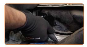
6 Entfernen Sie die Spritzschutzwand/WasserVanabdeckung.
