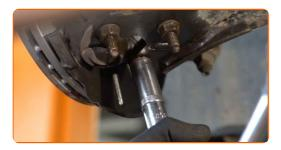
Sichern Sie den Bremsschauch-Befestigungswinkel. Befestigen Sie die Halterung des ABS-Kabelbaums. Verwenden Sie Ring-Gabelschlüssel Nr. 10.
