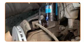
Reinigen Sie die untere Befestigung, die das Federbein mit dem Achsschenkel verbindet. Benutzen Sie eine Drahtbürste. Benutzen Sie WD-40-Spray.
