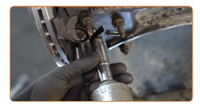
Setzen Sie den Antriebswellenschraube ein und ziehen Sie diese fest. Verwenden Sie Stecknuss Nr. 27. Verwenden Sie einen Ratschenschlüssel.
