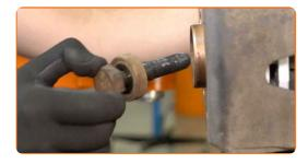
Reinigen Sie die Befestigungselemente, die das Kugelgelenk mit dem Aufhängungslenker verbinden. Benutzen Sie eine Drahtbürste. Benutzen Sie WD-40-Spray.
