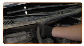
Reinigen Sie die Befestigungen der Wasserkastenabdeckung. Benutzen Sie eine Drahtbürste. Benutzen Sie WD-40-Spray.
