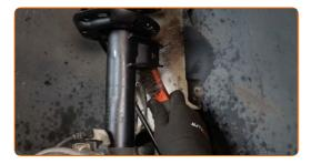
68 Montieren Sie den Querlenker.
