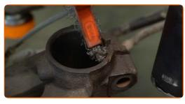
Befestigen Sie das Dämpferbein auf dem Achsschenkel.
