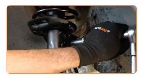
Behandeln Sie die Federbein-Befestigungen. Behandeln Sie alle Gelenke des Querlenkers. Behandeln Sie alle Gelenke der Koppelstange. Benutzen Sie ein Kupferschmiermittel.
