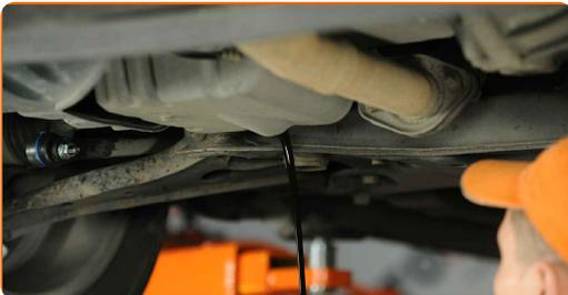
Austausch: Motoröl und Ölfilter – SUZUKI Carry Pritsche / Fahrgestell (FD, DA5\_T, DA6\_T). Tipp:
