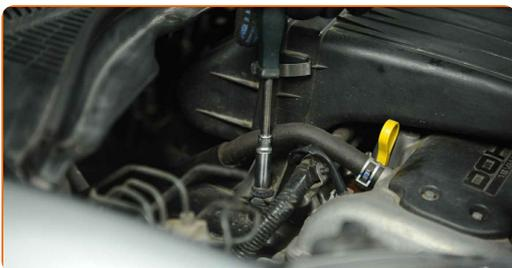
**5** Trennen Sie das Luftansaugrohr vom Luftfilter-Gehäuse.
