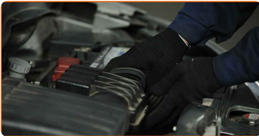
**27** Schrauben Sie die Filtergehäuse-Befestigungsbolzen an. Verwenden Sie Stecknuss Nr. 10. Verwenden Sie einen Ratschenschlüssel.
