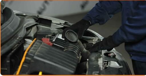
**6** Entfernen Sie das Luftfiltergehäuse.
