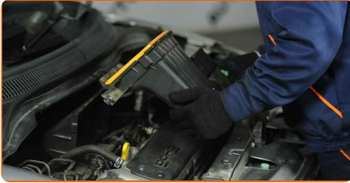
**26** Verbinden Sie das Luftansaugrohr mit dem Luftfilter-Gehäuse.
