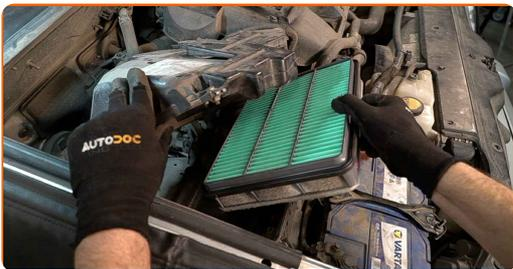
**6** Bedecken Sie den Luftansaugschlauch mit einem Mikrofaser Tuch, um zu vermeiden, dass Staub und Schmutz in das System gelangen.
