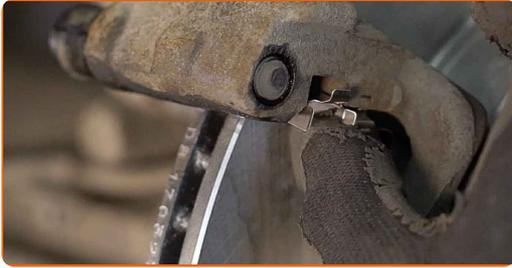
**15** Behandeln Sie den Bremssattel-Kolben. Benutzen Sie eine Drahtbürste. Benutzen Sie einen Bremsenreiniger.
