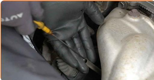
**4** Schrauben Sie die Öleinfüllschraube ab.
