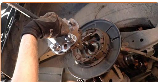
**21** Reinigen Sie den Einbauort für die Nabenlagerung. Benutzen Sie eine Drahtbürste. Benutzen Sie WD-40-Spray.
