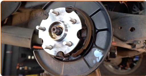
**23** Ziehen Sie die Radnabenlager an. Verwenden Sie Stecknuss Nr. 17. Verwenden Sie einen Ratschenschlüssel.
