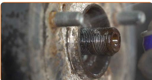
**11** Entfernen Sie die Antriebswelle. Verwenden Sie einen Splintentreiber. Benutzen Sie einen Hammer.
