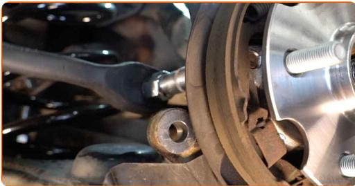
**24** Ziehen Sie das Befestigungselement des Radnabenlagers an. Verwenden Sie Stecknuss Nr. 17. Verwenden Sie einen Drehmomentschlüssel. Ziehen Sie ihn mit 90 Nm Drehmoment fest.
