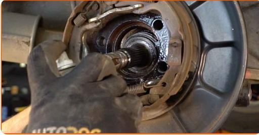
**22** Die neue Radnabe mit einem Lager montieren.
