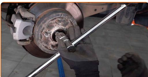
**10** Behandeln Sie die Keilwellen des Antriebswellen-Gleichlaufgelenks. Benutzen Sie WD-40-Spray.
