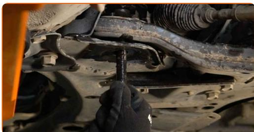
**23** Entfernen Sie den Arm. Benutzen Sie ein Brecheisen.
