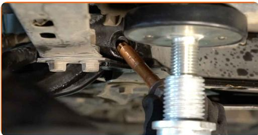
**27** Reinigen Sie alle Verbindungen des Querlenkers. Benutzen Sie eine Drahtbürste. Benutzen Sie WD-40-Spray.
