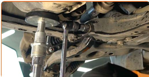
**19** Entfernen Sie die vordere Befestigung des Querlenkers.
