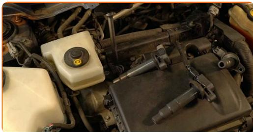
**19** Schrauben Sie die neuen Zündkerzen an und ziehen Sie diese fest. Verwenden Sie die Zündkerzennuss # 16. Verwenden Sie einen Drehmomentschlüssel. Ziehen Sie ihn mit 18 Nm Drehmoment fest.
