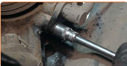
**22** Lösen Sie den ABS-Sensor. Verwenden Sie eine Wasserpumpenzange.
