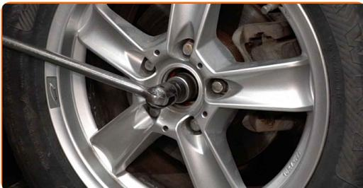
**5** Lösen Sie die Radhalterungsschrauben. Verwenden Sie eine Schlagnuss für Felgen # 19.
