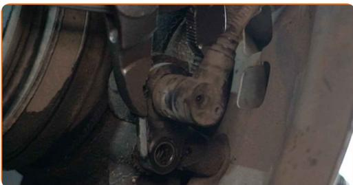
**23** Entfernen Sie den Sicherungsstift, der die Befestigung fixiert, die den Spurstangenkopf mit dem Achsschenkel verbindet. Benutzen Sie ein Brecheisen.
