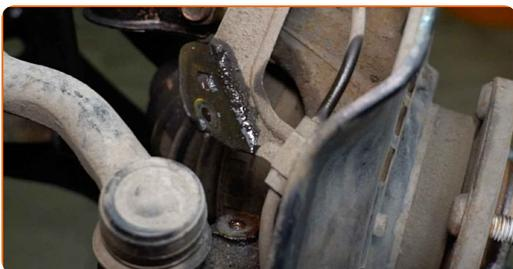
**20** Reinigen Sie die Befestigung des ABS-Sensors. Benutzen Sie eine Drahtbürste. Benutzen Sie WD-40-Spray.
