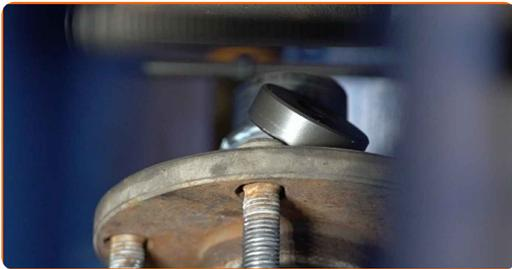
**42** Reinigen Sie den Sicherungsring des Radnabenlagers. Benutzen Sie eine Drahtbürste. Benutzen Sie WD-40-Spray.
