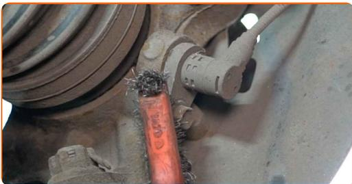
**21** Schrauben Sie die Befestigung des ABS-Sensors ab. Verwenden Sie Stecknuss Nr. 10. Verwenden Sie einen Ratschenschlüssel.
