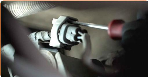
**3** Reinigen Sie die Befestigung der Lambdasonde. Benutzen Sie eine Drahtbürste. Benutzen Sie WD-40-Spray.
