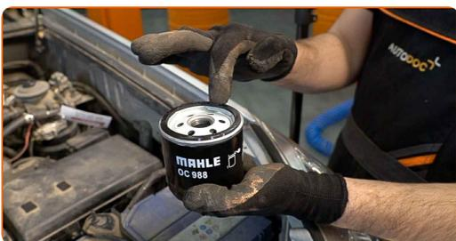
**19** Schrauben Sie den neuen Filter in seinen Platz. Verwenden Sie Steckschlüssel 76-14F. Verwenden Sie einen Drehmomentschlüssel. Ziehen Sie ihn mit 20 Nm Drehmoment fest.
