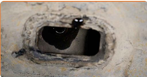
**13** Reinigen Sie den Bereich um die Ablassöffnung der Ölwanne.
