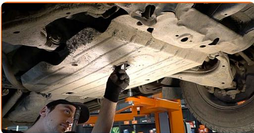
**14** Schrauben Sie die neue Ölablassschraube ein. Verwenden Sie Stecknuss Nr. 17. Verwenden Sie einen Ratschenschlüssel.
