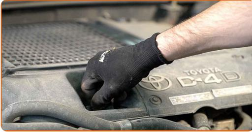
**24** Lassen Sie den Motor ein paar Minuten laufen. Nachdem die Ölstands-Warnleuchte erloschen ist, stoppen Sie den Motor.
