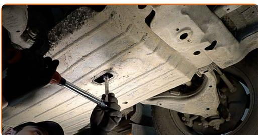
**15** Ziehen Sie die Ölablassschraube an. Verwenden Sie Stecknuss Nr. 17. Verwenden Sie einen Drehmomentschlüssel. Ziehen Sie ihn mit 30 Nm Drehmoment fest.
