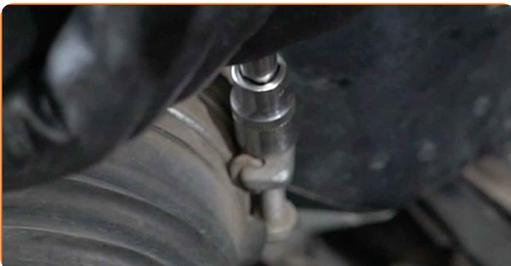
**4** Trennen Sie das Luftansaugrohr vom Luftfilter-Gehäuse.
