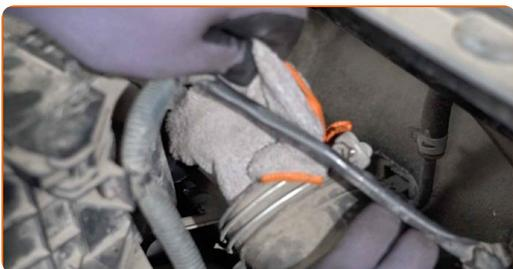
**34** Verbinden Sie das Luftansaugrohr mit dem Luftfilter-Gehäuse.
