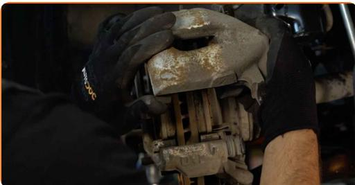
**Austausch: Bremsscheiben – TOYOTA COROLLA Stufenheck (E15\_).**
