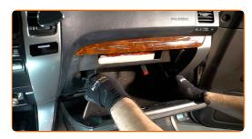
Entfernen Sie das Luftfiltergehäuse.
