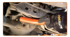
Drehen Sie das Befestigungselement auf, das die Koppelstange mit dem Querlenker verbindet. Verwenden Sie Stecknuss Nr. 17.
