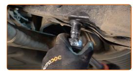
Ziehen Sie das Befestigungselement an, das die Druckstange mit dem Stabilisator verbindet. Verwenden Sie Stecknuss Nr. 17. Verwenden Sie einen Drehmomentschlüssel. Ziehen Sie ihn mit 74 Nm Drehmoment fest.
