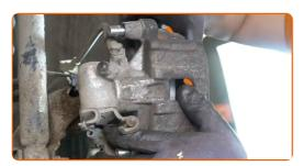
Ziehen Sie die Bremssattelbefestigungen fest. Verwenden Sie Inbusschlüssel Nr. H7. Verwenden Sie einen Drehmomentschlüssel. Ziehen Sie ihn mit 34 Nm Drehmoment fest.
