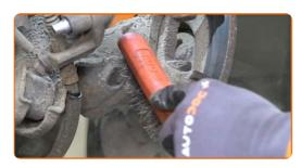
Schrauben Sie die Befestigungen des Bremssattelhalters ab. Verwenden Sie Stecknuss Nr. 14. Verwenden Sie einen Ratschenschlüssel.
