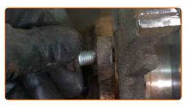
Ziehen Sie die Befestigungen des Bremssattelhalters fest. Verwenden Sie Stecknuss Nr. 14. Verwenden Sie einen Drehmomentschlüssel. Ziehen Sie ihn mit 57 Nm Drehmoment fest.
