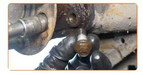
Entfernen Sie die Nabe und das Lager zusammen, da sie als Baugruppe gefertigt sind. Benutzen Sie ein Brecheisen. Benutzen Sie einen Hammer.
