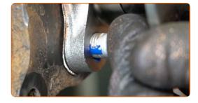
Ziehen Sie die Befestigungen des Radnabenlagers an. Verwenden Sie Stecknuss Nr. 14. Verwenden Sie einen Drehmomentschlüssel. Ziehen Sie ihn mit 90 Nm Drehmoment fest.
