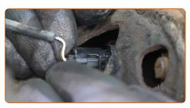
Säubern Sie die Halterung des Bremssattels. Benutzen Sie eine Drahtbürste. Benutzen Sie einen Bremsenreiniger.
