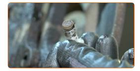
15 Entfernen Sie die Sattelhalterung.
