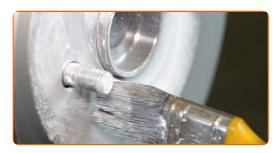
Die Bremsscheibenoberfläche reinigen. Benutzen Sie einen Bremsenreiniger.
