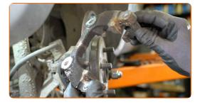
Entfernen Sie die Bremsscheibe.
