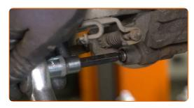
Installieren Sie die Staubschutzkappen der Bremssattel-Führungsstifte.
