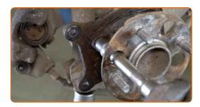
Entfernen Sie die Befestigungsschrauben.
