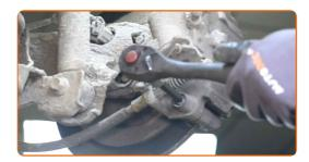
Entfernen Sie den Bremssattel. Benutzen Sie ein Brecheisen.
