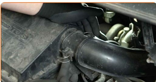
**4** Trennen Sie den Ansaugschlauch vom Luftfiltergehäuse.
