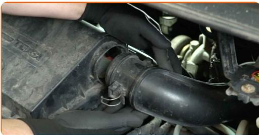
**5** Lösen Sie die Halteklammern der Luftfilterabdeckung.
