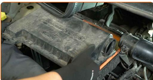
**7** Stopfen Sie den Ansaugschlauch mit einem Mikrofaser Tuch ab, um zu vermeiden, dass Staub und Schmutz in das Luftfilter-System gelangen.
