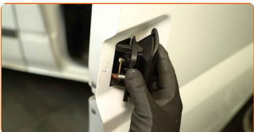
**6** Ziehen Sie die Befestigungsmutter des Türgriffs fest. Verwenden Sie eine Stecknuss mit einem Durchmesser von 10 mm. Verwenden Sie einen Drehmomentschlüssel. Anzugsdrehmoment: 10 N·m.
