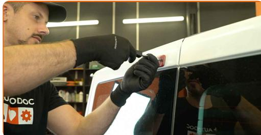
**2** Entfernen Sie die Befestigungsschrauben.
