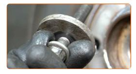
Reinigen Sie die Befestigungen des Bremsenabdeckblechs. Benutzen Sie eine Drahtbürste. Benutzen Sie WD-40-Spray.
