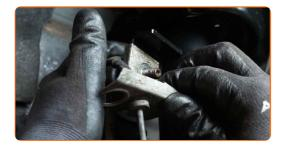
Schrauben Sie die Befestigung ein, die die Koppelstange mit dem Federbein verbindet. Verwenden Sie Stecknuss Nr. 15. Verwenden Sie einen Ratschenschlüssel.
