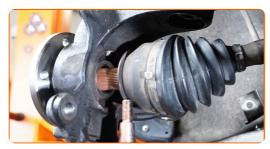
Verbinden Sie das Traggelenk mit dem Achsschenkel. Benutzen Sie ein Brecheisen.
