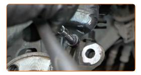
Entfernen Sie die Befestigungsschrauben.
