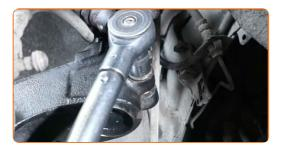
Ziehen Sie die Befestigungen des Bremssattelhalters fest. Verwenden Sie Stecknuss Nr. 18. Verwenden Sie einen Drehmomentschlüssel. Ziehen Sie ihn mit 150 Nm Drehmoment fest.
