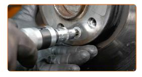
Entfernen Sie die Befestigungsschraube.
