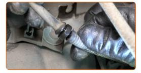
Schrauben Sie das Befestigungselement heraus, das die Druckstange mit dem Federbein verbindet. Verwenden Sie Stecknuss Nr. 15. Verwenden Sie einen Ratschenschlüssel.
