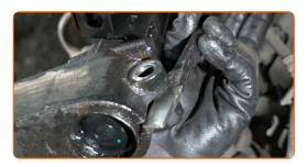
Lösen Sie den Achsschenkel vom Federbein. Verwenden Sie einen Gummi-Hammer.
