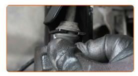
Schrauben Sie die unteren Befestigungen des Federbeins fest. Verwenden Sie Stecknuss Nr. 15. Verwenden Sie einen Drehmomentschlüssel. Ziehen Sie ihn mit 110 Nm Drehmoment fest.
