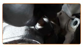
Entfernen Sie die Stütze unter dem Achsschenkel.
