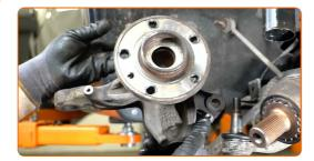
Reinigen Sie die Montagesitze des Federbeins auf dem Achsschenkel. Benutzen Sie eine Drahtbürste.
