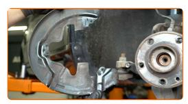
Reinigen Sie den Stecker des ABS-Sensors. Verwenden Sie eine Nylon-Reinigungsbürste. Verwenden Sie Allzweckreinigungsspray.
