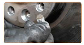
18 Entfernen Sie die Bremsscheibe.
