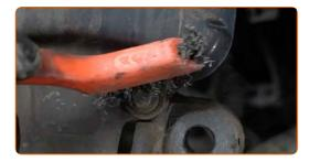
Lösen Sie die Befestigungen des Bremsenabdeckblechs. Verwenden Sie Stecknuss Nr. 8. Verwenden Sie einen Ratschenschlüssel.
