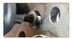
Schrauben Sie die Befestigungen der Bremsscheibe fest. Verwenden Sie den Torx T50. Verwenden Sie einen Drehmomentschlüssel. Ziehen Sie ihn mit 15 Nm Drehmoment fest.
