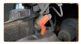
Schrauben Sie das untere Befestigungselement ab, dass das Federbein mit dem Achsschenkel verbindet. Verwenden Sie Stecknuss Nr. 15. Verwenden Sie einen Ratschenschlüssel.
