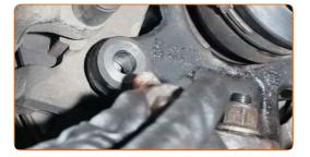
Schrauben Sie die Befestigungen des Bremssattelträgers ein. Verwenden Sie Stecknuss Nr. 18. Verwenden Sie einen Ratschenschlüssel.
