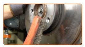
Schrauben Sie die Befestigungen der Bremsscheibe ab. Verwenden Sie den Torx T50. Verwenden Sie einen Schlagschrauber. Benutzen Sie einen Hammer.
