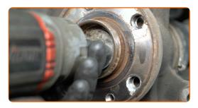
20 Entfernen Sie die Befestigungsschraube.
