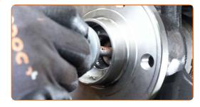
Schrauben Sie die Befestigungen der Antriebswelle an. Verwenden Sie Stecknuss Nr. 13. Verwenden Sie einen Ratschenschlüssel.
