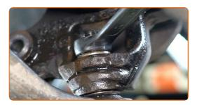
Trennen Sie das Traggelenk vom Achsschenkel. Verwenden Sie einen Kugelgelenkabzieher. Benutzen Sie ein Brecheisen.
