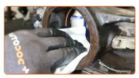
Bauen Sie die neue Radnabe gemeinsam mit dem Lager ein. Verwenden Sie einen Druckstücksatz mit Ein-/Auspresswerkzeug. Verwenden Sie ein ein Trennmesser für Lager.
