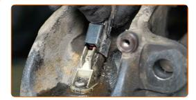
27 Trennen Sie die Verkabelung des ABS-Sensors.
