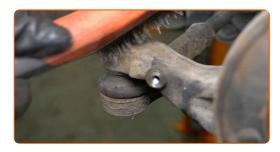
Schrauben Sie die Befestigungsmutter ab, die den Spurstangenkopf mit dem Achsschenkel verbindet. Verwenden Sie Stecknuss Nr. 22. Verwenden Sie einen Ratschenschlüssel.
