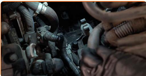
**20** Reinigen Sie den Getriebe-Entlüfter. Verwenden Sie Allzweckreinigungsspray.
