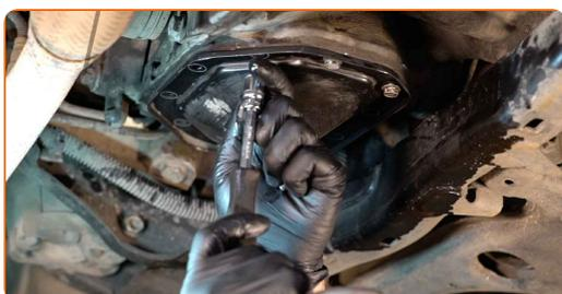
**19** Entfernen Sie die Halterungen und legen Sie die Kühlmittleitung zur Seite.
