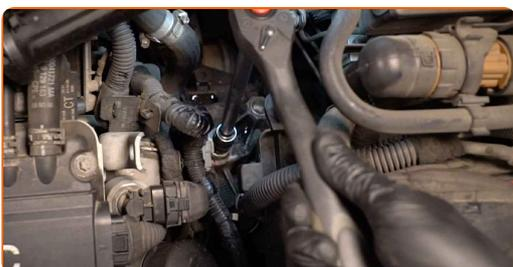
**22** Setzen Sie den Trichter ein. Füllen Sie durch das Entlüftungsloch neues Getriebeöl in das Getriebe. Erforderliche Menge an Öl: 1.6 l.
