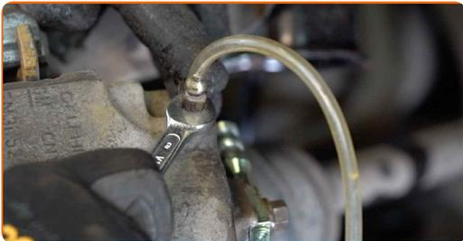
**23** Drücken Sie mehrere Male auf das Bremspedal, um jegliche Luft aus dem System entweichen zu lassen.
