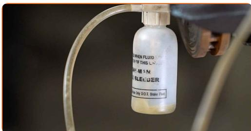
**22** Lösen Sie die Bremsentlüftungsschraube. Verwenden Sie Ring-Gabelschlüssel Nr. 9.
