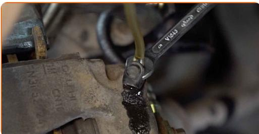
**25** Trennen Sie den Schlauch des Bremsentlüftungs-Kits.
