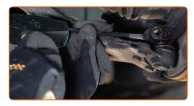
Entfernen Sie den Arm. Benutzen Sie ein Brecheisen.
