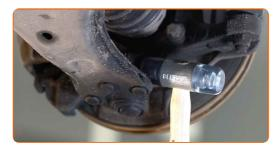
Schrauben Sie die vordere Armbefestigung ab. Verwenden Sie Stecknuss Nr. 18. Verwenden Sie Ring-Gabelschlüssel Nr. 18. Verwenden Sie einen Ratschenschlüssel.
