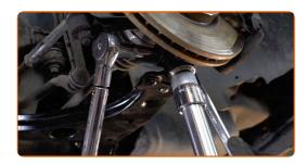
Schrauben Sie die vordere Armbefestigung an. Verwenden Sie Stecknuss Nr. 18. Verwenden Sie Ring-Gabelschlüssel Nr. 18. Verwenden Sie einen Drehmomentschlüssel. Ziehen Sie ihn mit 90 Nm Drehmoment fest.+75°
