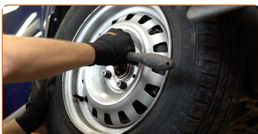
**32** Senken Sie das Auto und ziehen Sie die Radschrauben über Kreuz an. Verwenden Sie einen Drehmomentschlüssel. Ziehen Sie ihn mit 110 Nm Drehmoment fest.
