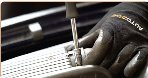
**40** Entfernen Sie die Kotflügel-Abdeckung.
