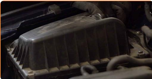
**36** Bringen Sie die Befestigungen an, die die Luftleitung und den Kabelbaum mit dem Luftfiltergehäuse verbinden.
