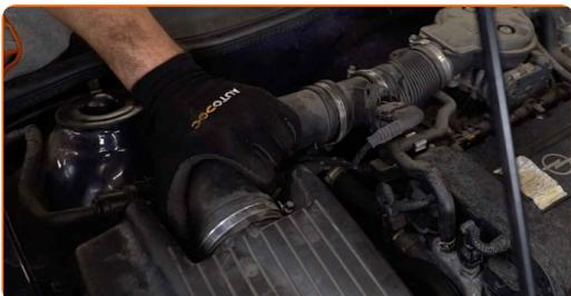
**39** Ziehen Sie die Klemme am Luftansaugschlauch fest. Verwenden Sie Stecknuss Nr. 7. Verwenden Sie einen Ratschenschlüssel.
