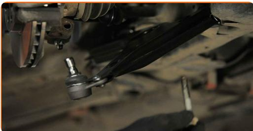
**20** Verbinden Sie das Kugelgelenk mit dem Achsschenkel. Verwenden Sie einen Gummi-Hammer.
