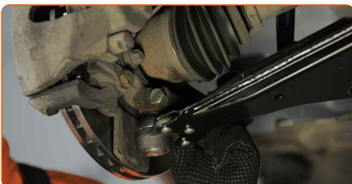
**22** Ziehen Sie das Befestigungselement fest, das das Traggelenk mit dem Achsschenkel verbindet. Verwenden Sie Ring-Gabelschlüssel Nr. 18. Verwenden Sie Stecknuss Nr. 18. Verwenden Sie einen Drehmomentschlüssel. Ziehen Sie ihn mit 50 Nm Drehmoment fest.
