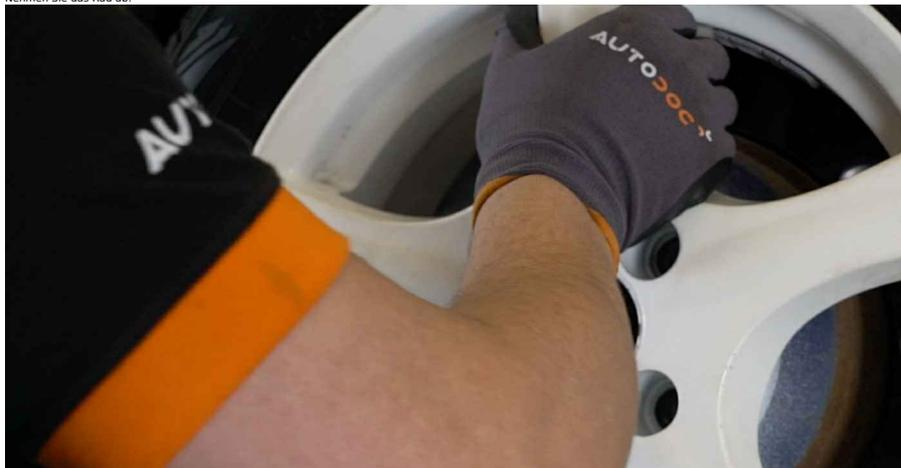
6 Entfernen Sie die Radnabenkappe. Benutzen Sie ein Brecheweis. Benutzen Sie einen Hammer.
