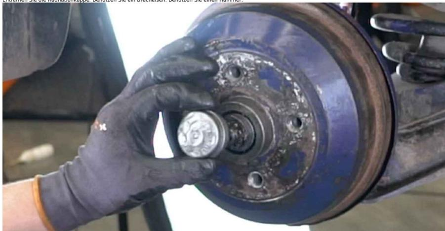
7 Entfernen Sie den Splint, der die Nabenmutter sichert. Benutzen Sie ein Brecheweis. Verwenden Sie einen flachen Schraubendreher.
