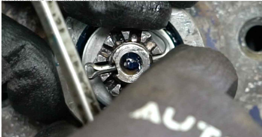
34 Installieren Sie die Kappe der Nabenmutter. Verwenden Sie einen Gummi-Hammer.
