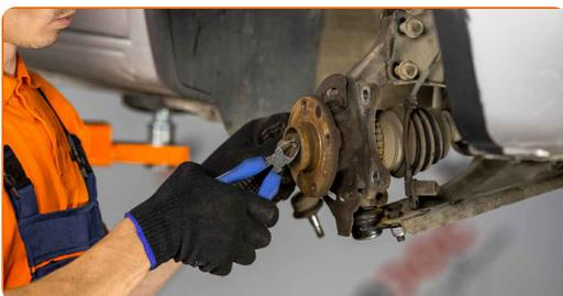
**24** Lösen Sie die Befestigungsmutter der Radnabe. Verwenden Sie Stecknuss Nr. 30. Verwenden Sie ein Windeisen.
