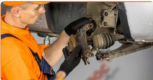
**35** Verbinden Sie das Kugelgelenk mit dem Achsschenkel.
