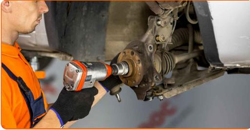
**25** Entfernen Sie die Befestigungsschraube.
