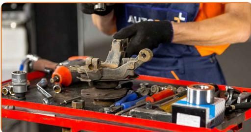
**28** Drücken Sie die Radnabe aus dem Kegelrollenlager. Verwenden Sie einen Druckstücksatz mit Ein-/Auspresswerkzeug. Benutzen Sie einen Hammer.
