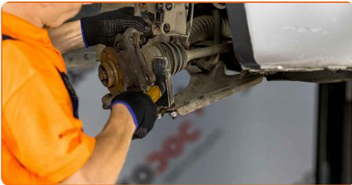
**27** Entfernen Sie die Achsschenkel zusammen mit der Nabe.
