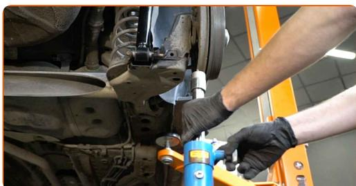
Austausch: Stoßdämpfer – VAUXHALL Corsa Mk III (D) Schrägheck (S07).
