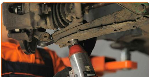
**20** Verbinden Sie das Kugelgelenk mit dem Achsschenkel. Benutzen Sie ein Brecheisen. Verwenden Sie einen Gummi-Hammer.
