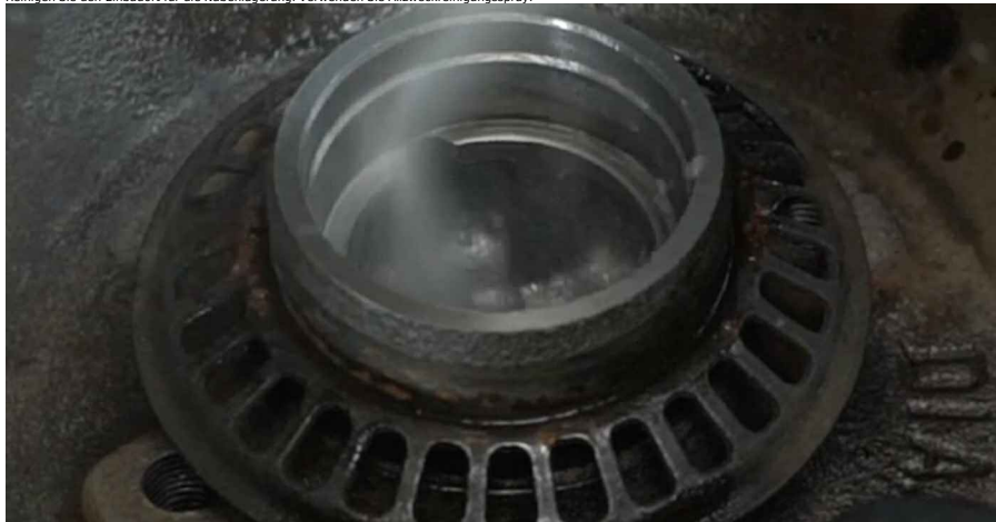
18 Installieren Sie einen neuen Radlager-Außenring in der Bremstrommel. Druckstücksatz, Ein-/Auspresswerkzeug.
