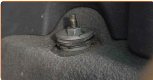
**4** Reinigen Sie die Befestigungselemente des Stoßdämpferdomlagers. Benutzen Sie WD-40-Spray.
