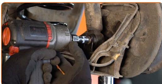
**14** Entfernen Sie die Befestigungsschraube.
