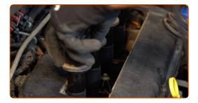
Entfernen Sie Schmutz, Staub und Ablagerungen von den Zündkerzenbohrung.
