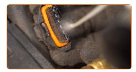
Schließen Sie den Anschluss der Zündspule an.
