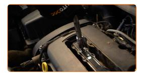
Heben Sie die Zündspule an. Benutzen Sie ein Brecheisen. Entnehmen Sie die Zündspule aus der Vertiefung für die Zündkerze.
