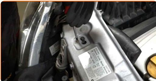
**4** Entferne die Komponenten des Lüftungskanals.
