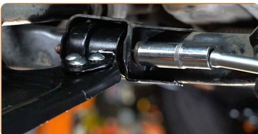
**18** Verbinden Sie den Unterarm mit dem Achsschenkel.
