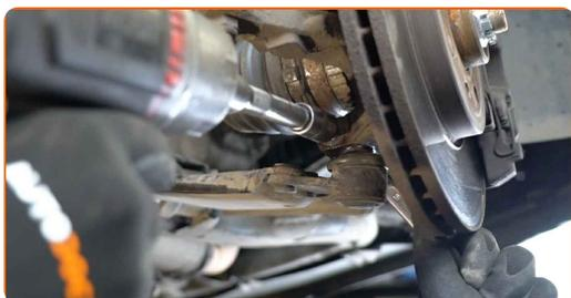
**8** Entfernen Sie die Befestigungsschraube. Verwenden Sie Ring-Gabelschlüssel Nr. 16.
