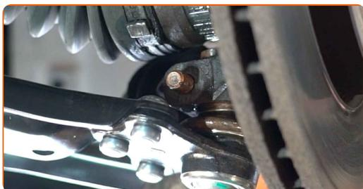
**20** Schrauben Sie die Befestigungen des Kugelgelenks ein. Verwenden Sie Ring-Gabelschlüssel Nr. 16. Verwenden Sie Stecknuss Nr. 16. Verwenden Sie einen Ratschenschlüssel.
