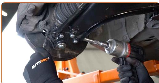
**21** Ziehen Sie das Kugelgelenk an. Verwenden Sie Ring-Gabelschlüssel Nr. 16. Verwenden Sie Stecknuss Nr. 16. Verwenden Sie einen Drehmomentschlüssel. Ziehen Sie ihn mit 55 Nm Drehmoment fest.
