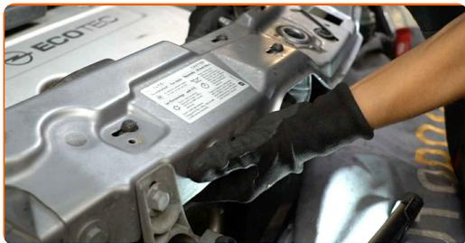
**30** Schraube die Befestigungselemente des Lüftungskanals ein. Verwenden Sie den Torx T20.
