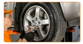
Senken Sie das Auto und ziehen Sie die Radschrauben über Kreuz an. Verwenden Sie eine Schlagnuss für Felgen # 17. Verwenden Sie einen Drehmomentschlüssel. Ziehen Sie ihn mit 130 Nm Drehmoment fest.
