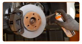
Die Bremsscheibenoberfläche reinigen. Benutzen Sie einen Bremsenreiniger.
