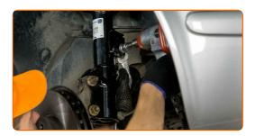
Ziehen Sie das Befestigungselement an, das die Druckstange mit dem Stabilisator verbindet. Verwenden Sie Ring-Gabelschlüssel Nr. 18. Verwenden Sie den Torx T40. Verwenden Sie einen Drehmomentschlüssel. Ziehen Sie ihn mit 85 Nm Drehmoment fest.
