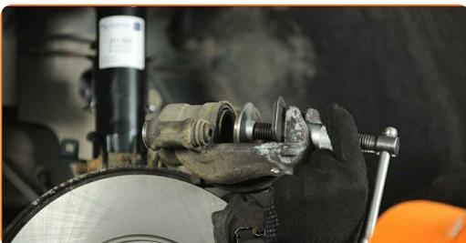
**32** Installieren Sie den Bremssattel und fixieren Sie diesen.
