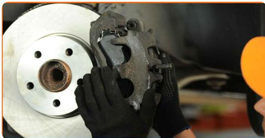
**33** Schrauben Sie die Führungsbolzen hinein.
