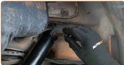
**16** Ziehen Sie den unteren Befestiger des Stoßdämpfers an. Verwenden Sie Stecknuss Nr. 21. Verwenden Sie einen Drehmomentschlüssel. Ziehen Sie ihn mit 130 Nm Drehmoment fest.
