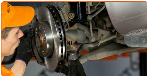
**16** Ziehen Sie die Befestigungsmutter an, die den Spurstangenkopf mit dem Achsschenkel verbindet. Verwenden Sie Stecknuss Nr. 21. Verwenden Sie einen Drehmomentschlüssel. Ziehen Sie ihn mit 50 Nm Drehmoment fest.+60°
