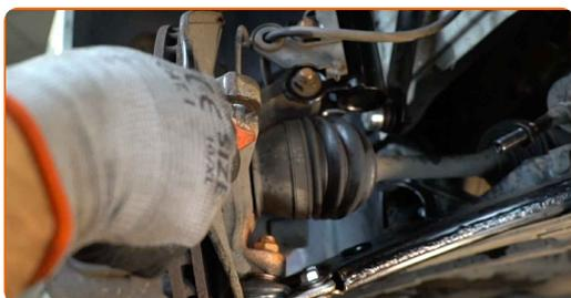
**14** Schrauben Sie einen neuen Spurstangenkopf an.
