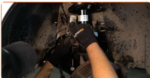
**13** Ziehen Sie das Befestigungselement an, das die Druckstange mit dem Stabilisator verbindet. Verwenden Sie Ring-Gabelschlüssel Nr. 15. Verwenden Sie Ring-Gabelschlüssel Nr. 17. Verwenden Sie einen Drehmomentschlüssel. Ziehen Sie ihn mit 70 Nm Drehmoment fest.
