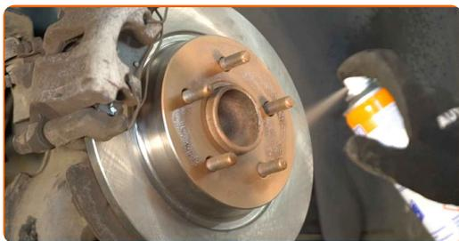
**20** Die Bremsscheibenoberfläche reinigen. Benutzen Sie einen Bremsenreiniger.
