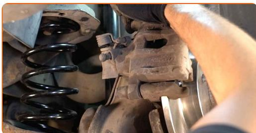
**18** Bauen Sie die Bremssattel-Haltefeder ein. Verwenden Sie einen Gummi-Hammer.
