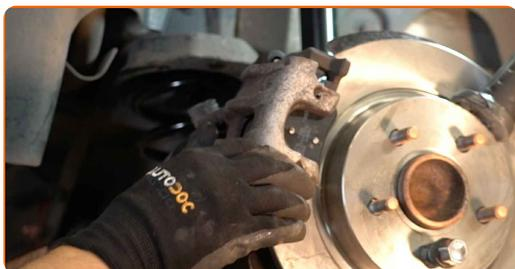
**17** Installieren Sie die Staubschutzkappen der Bremssattel-Führungsstifte.
