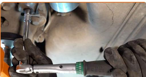
**19** Drehen Sie die Kappe des Druchregelventils ein.
