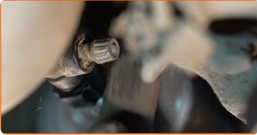
**20** Den Flüssigkeitsbehälter unter dem Kraftstofffilter entfernen.
