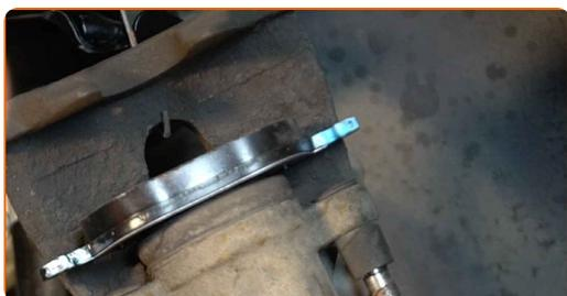
**25** Installieren Sie den Bremssattel und fixieren Sie diesen.
