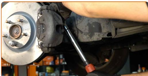
**28** Installieren Sie die Staubschutzkappen der Bremssattel-Führungsstifte.
