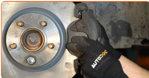
**26** Bauen Sie die Bremssattel-Haltefeder ein. Verwenden Sie Inbusschlüssel Nr. H7. Verwenden Sie einen Ratschenschlüssel.
