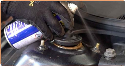
**4** Lösen Sie die obere Befestigung des Domlagers. Verwenden Sie Stecknuss Nr. 13. Verwenden Sie einen Ratschenschlüssel.
