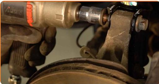
**47** Ziehen Sie die unteren Befestigungen an, die das Federbein mit dem Achsschenkel verbinden. Verwenden Sie Ring-Gabelschlüssel Nr. 18. Verwenden Sie Stecknuss Nr. 21. Verwenden Sie einen Drehmomentschlüssel. Ziehen Sie ihn mit 105 Nm Drehmoment fest.+60°
