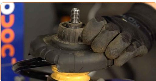
**36** Schrauben Sie das Befestigungselement des Federbeinstützlers ein. Verwenden Sie Inbusschlüssel Nr. H6. Verwenden Sie einen Ratschenschlüssel. Verwenden Sie eine Wasserpumpenzange.
