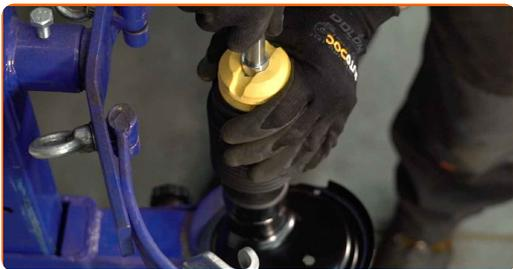
**33** Installieren Sie die Feder am Stoßdämpfer.
