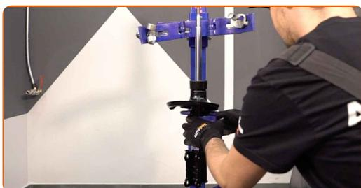
**32** Installieren Sie die Staubschutzmanschette und den Anschlagpuffer auf dem neuen Stoßdämpfer.
