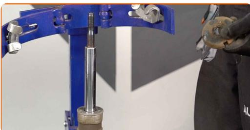
**29** Die Staubkappe des Stoßdämpfers und den Anschlagpuffer entfernen.
